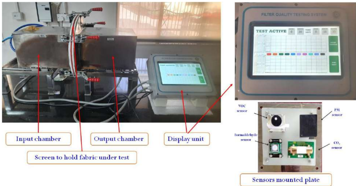
चित्र 2.8. कपड़े की हवा निस्यंदन क्षमता मूल्यांकन के लिए उपकरण
