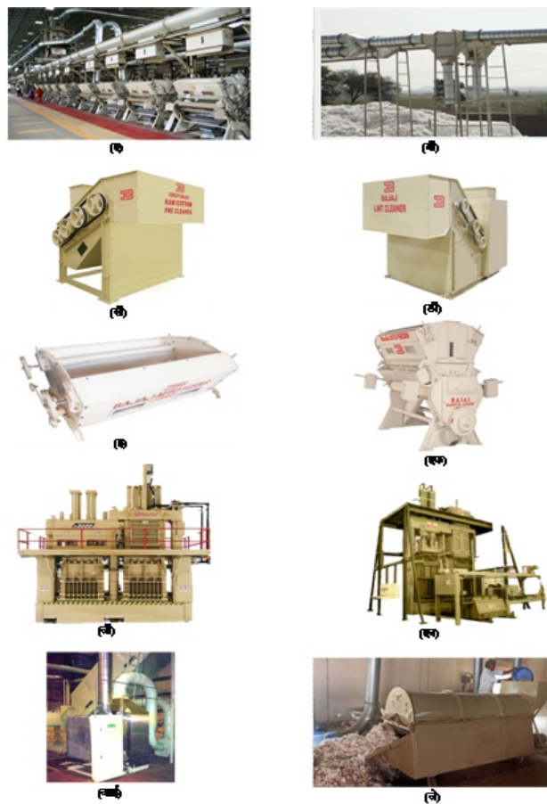
चित्र 3: (ए) कपास एवं रूई परिवहन प्रणाली (बी) कपास बीज परिवहन प्रणाली (सी) सिरकॉट-बजाज प्री-क्लीनर (डी) बजाज लिंट क्लीनर (ई) बजाज ऑटो-फीडर (एफ) बजाज उच्च क्षमता वाला डबल रोलर जिन (जी) डाउन-पैकिंग बेल प्रेस (एच) अप-पैकिंग बेल प्रेस (आई) गरम वायु आर्द्रिकरण प्रणाली (जे) सिरकॉट कवड़ी कपास बॉल ओपनर
