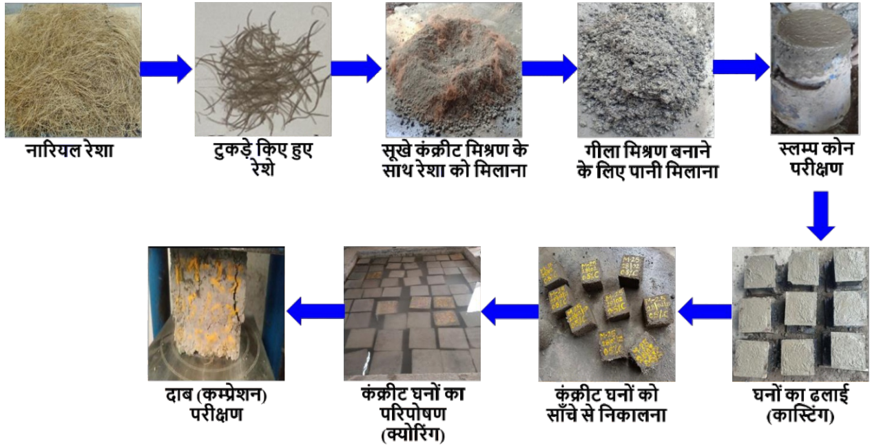
चित्र 2. रेशा मिलाकर कंक्रीट घन तैयार करने की प्रक्रिया
