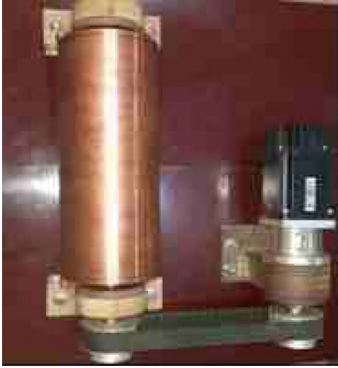
चित्र: 2.36 (ए) निर्मित घूर्णी ड्रम संग्रहक संरेखित नैनोफाइबर उत्पादन करने के लिए
